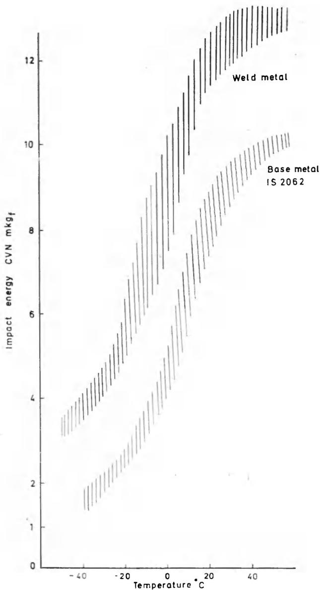
Fig. 5 : Notch toughness of IS 2062 steel
