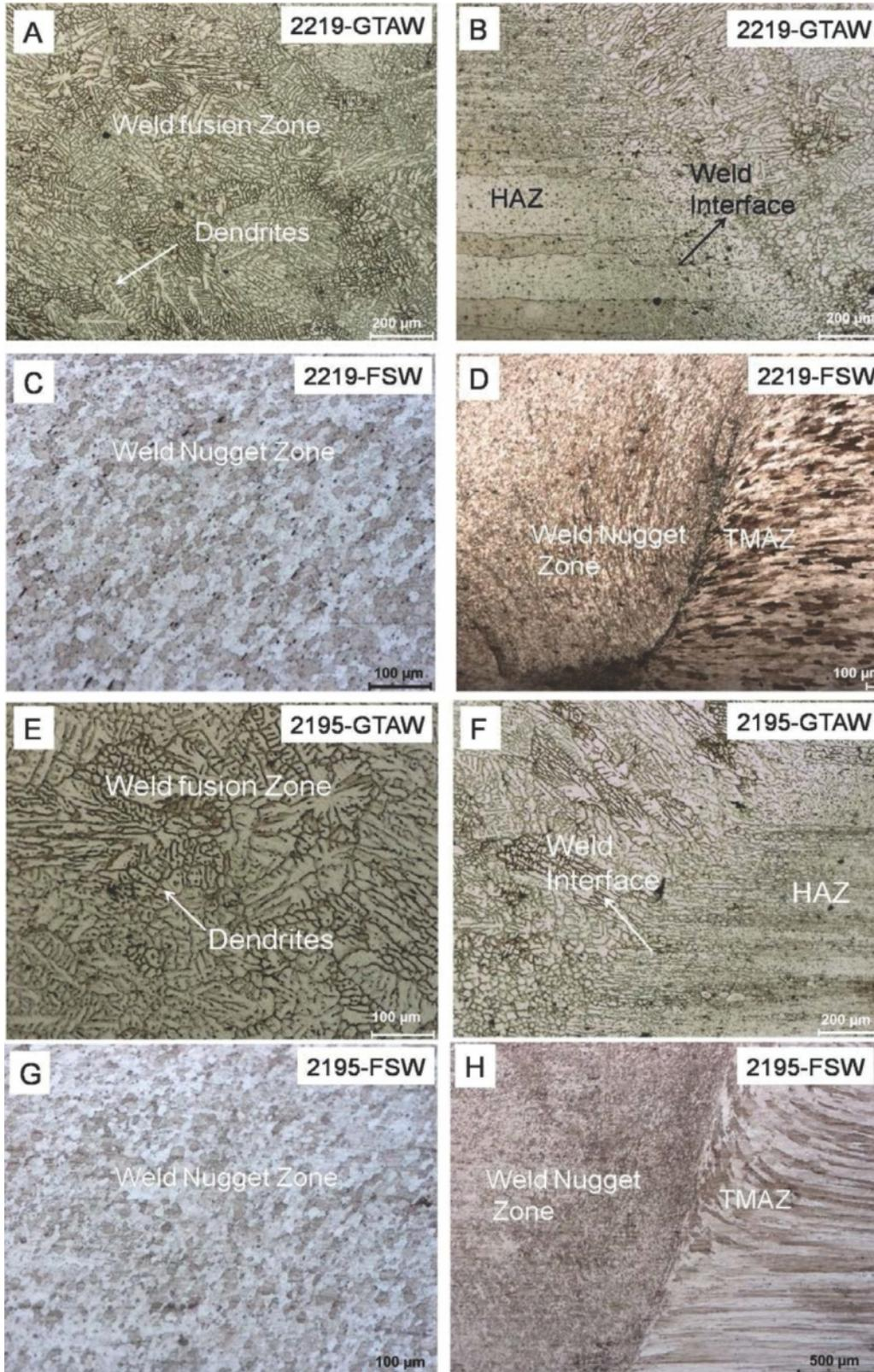
**Fig. 2 : Weld microstructures A) and B) 2219-GTA weld, C) and D) 2219-FSW weld E) and F) 2195-GTA weld G) and H) 2195-FSW weld**
