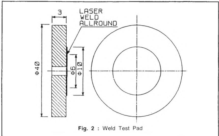
Fig. 2 : Weld Test Pad
