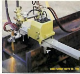
Mini Mantis Beam cut
