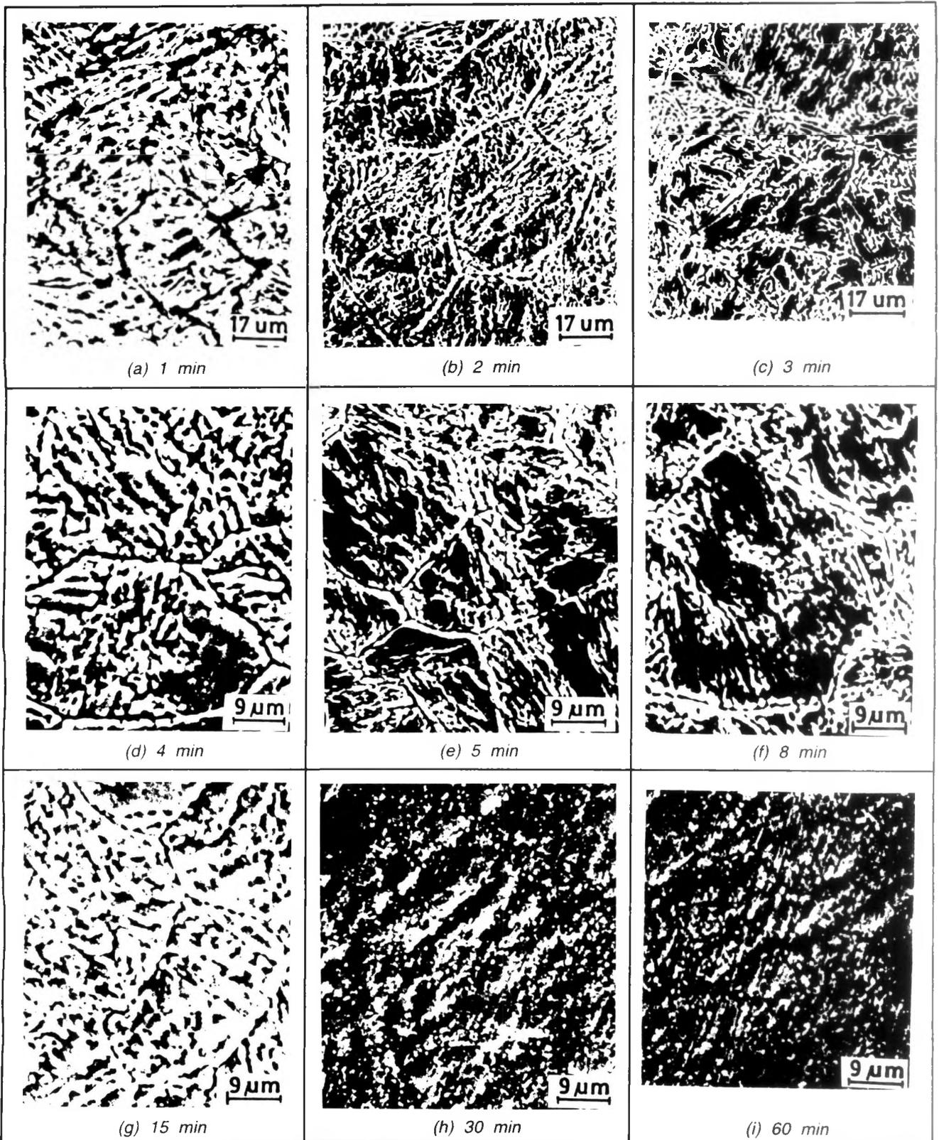
Fig. 17 Scanning electron micrographs of weld simulated sample after potentiostatic etching; austenised, ice-quenched and tempered for (a) 1 min, (b) 2 min, (c) 3 min, (d) 4 min, (e) 5 min, (f) 8 min, (g) 15 min, (h) 30 min, (i) 60 min
