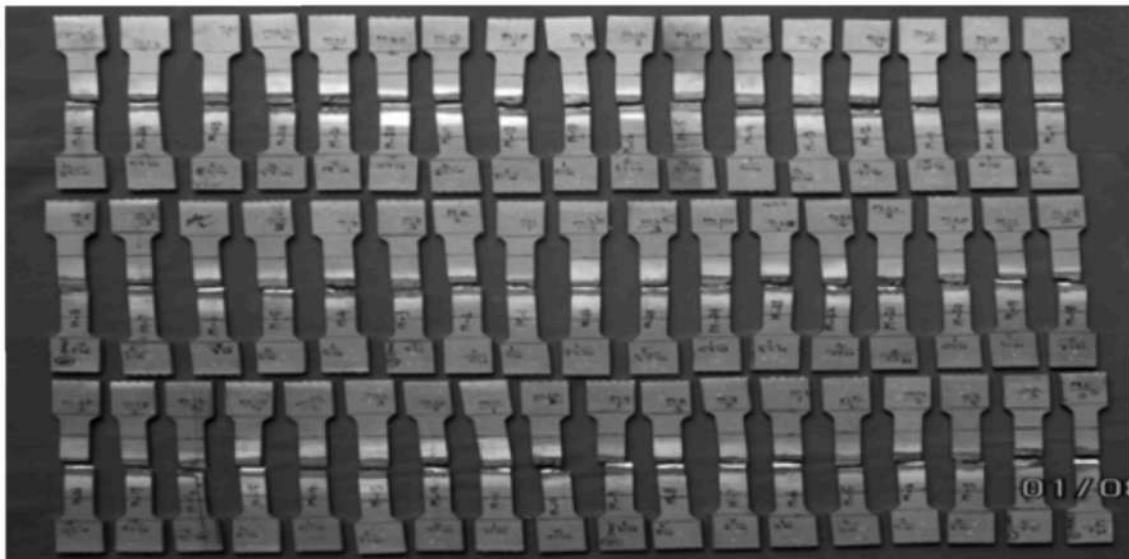
( c ) Tensile specimens (after tensile test)
