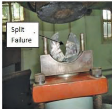
(d) Sample showing failure
